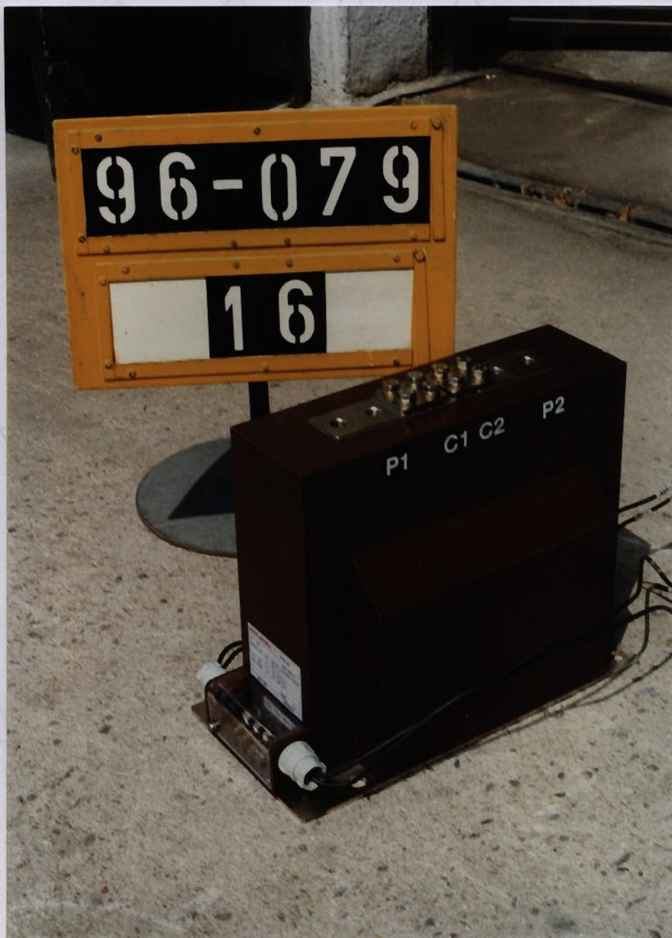
obr.4 Přístrojový transformátor proudu CTS 25 v.č.2500002 po zkoušce. (foto 96-079/16)
