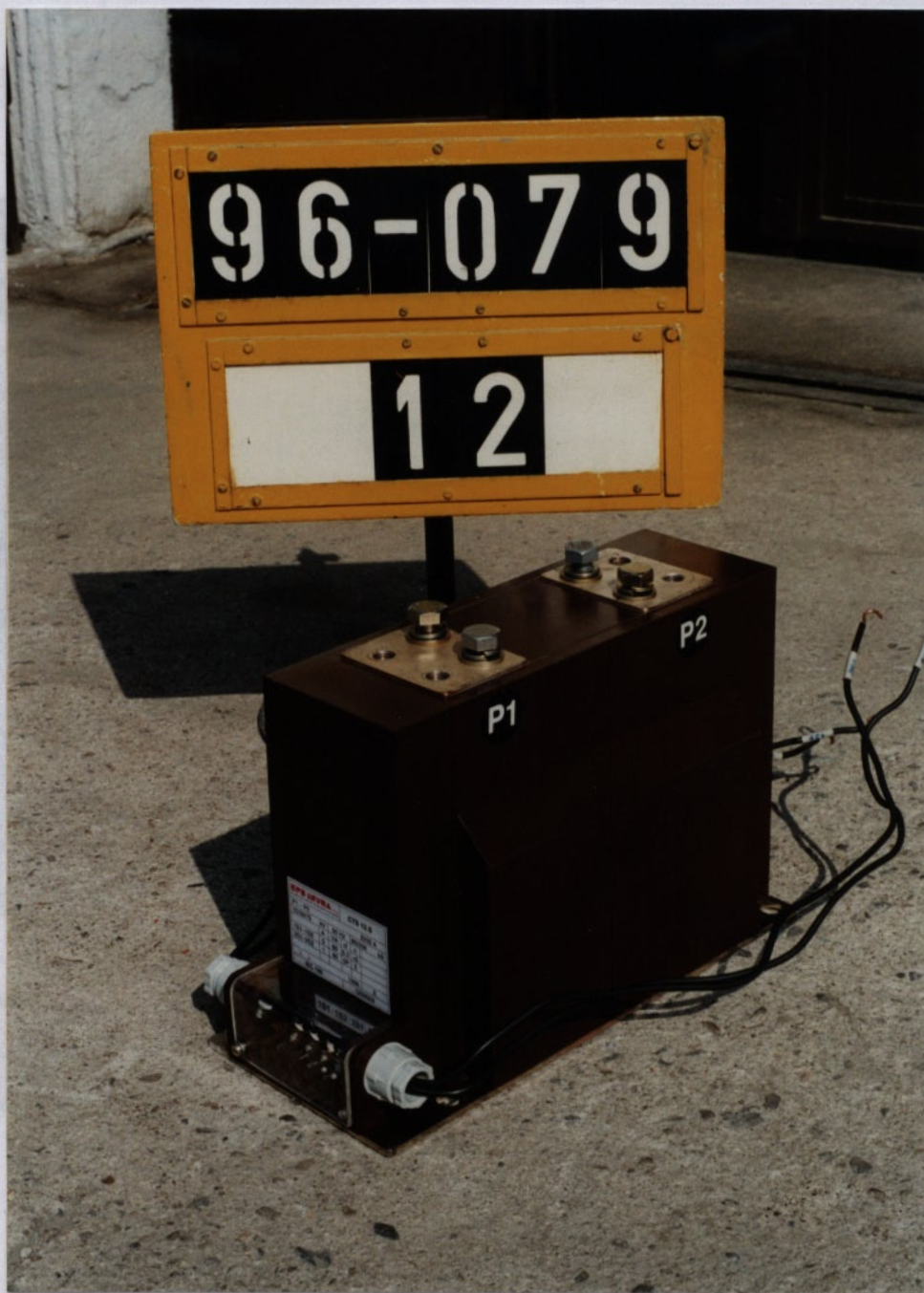
obr.2 Přístrojový transformátor proudu CTS 12.S v.č. 1200003 po zkoušce. (foto 96-079/12)
